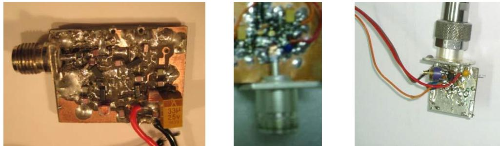
Slike 4.11. – 4.13. Prototipovi negativnih kondenzatora (lijevo i u sredini – FET tehnologija, desno – izvedeno pomoću operacijskih pojačala)
