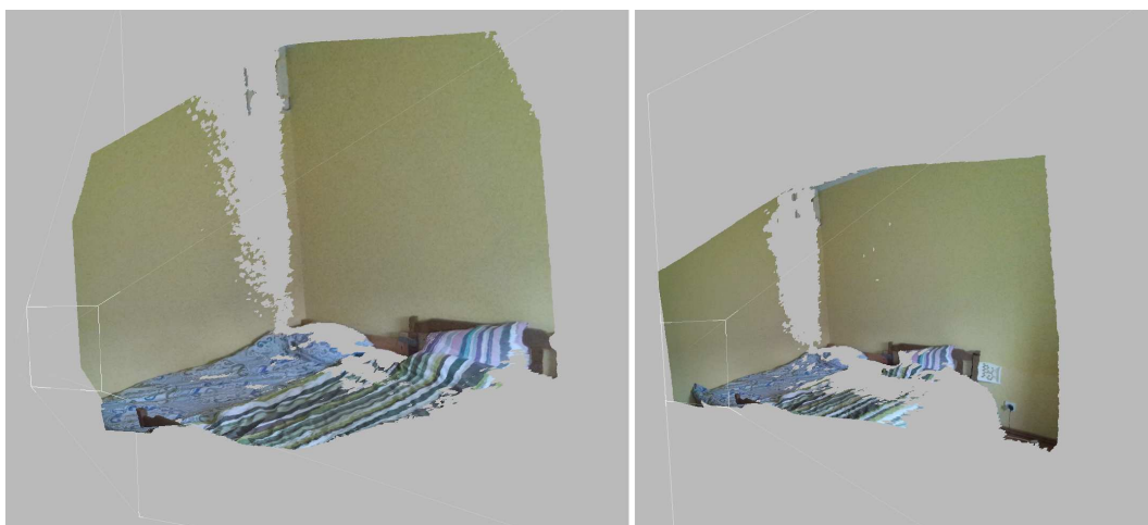
Slika 4.4: Lijeva slika prikazuje način rada kamere kod užeg vidnog područja ( 75^\circ ), dok desna prikazuje način rada sa širim vidnim poljem ( 120^\circ ).
