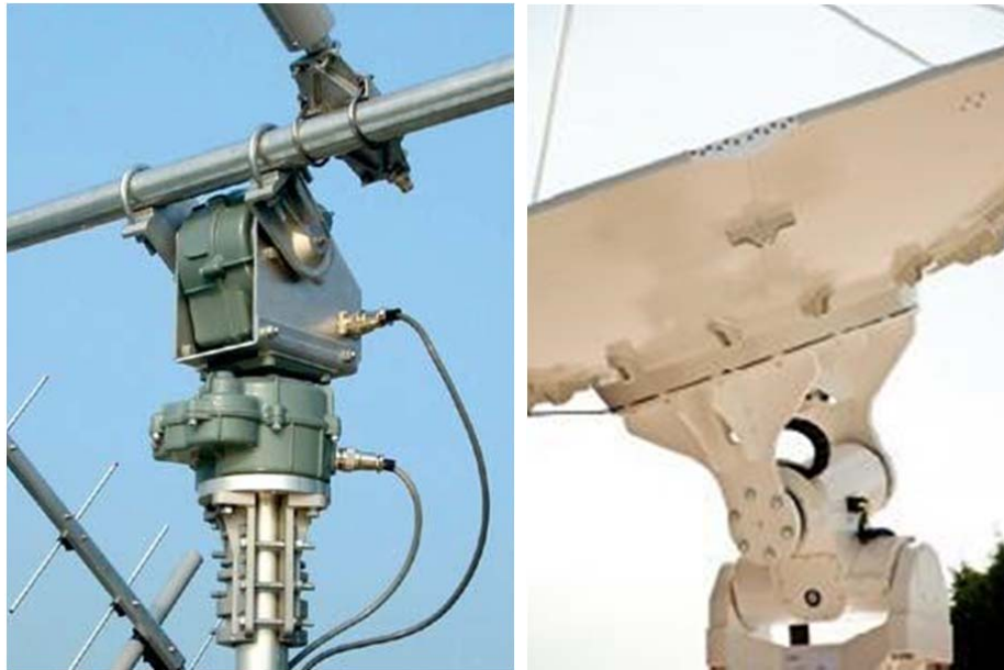
Slika @2: (a) Primjer motorizirane AZ/EL kontrole i (b) primjer motorizirane X/Y kontrole.
