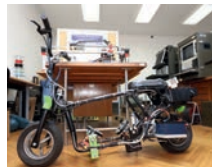
▲ Samostabilizirajući motocikl zasnovan na žiroskopskom efektu primjenom sustava zamašnjaka primjer je uspjeloga studentskog projekta u području mehatronike. Prva prototipna verzija razvijena je kao diplomski rad Filipa Ivančića
