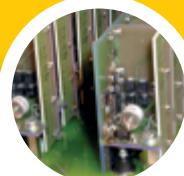
Primjer ulaznog dijela sustava za snimanje biomedicinačkih napona amplitude 400 nV koji mora raditi uz prisutnost smetnji amplitude 100 V. Slika prikazuje 3D strukturu koja sadrži ultra-niskošumno pojačalo velike ulazne impedancije te njegove zaštitne komponente.
