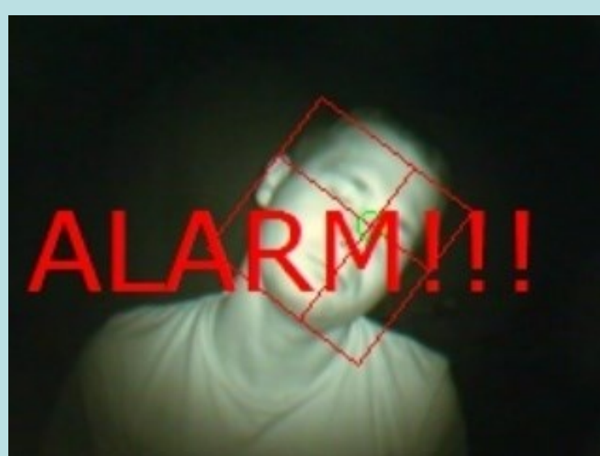
Slika 5.: Primjer detektirane pospanosti
