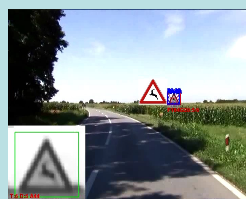
Slika 8.: Postupak raspoznavanja detektiranog znaka
