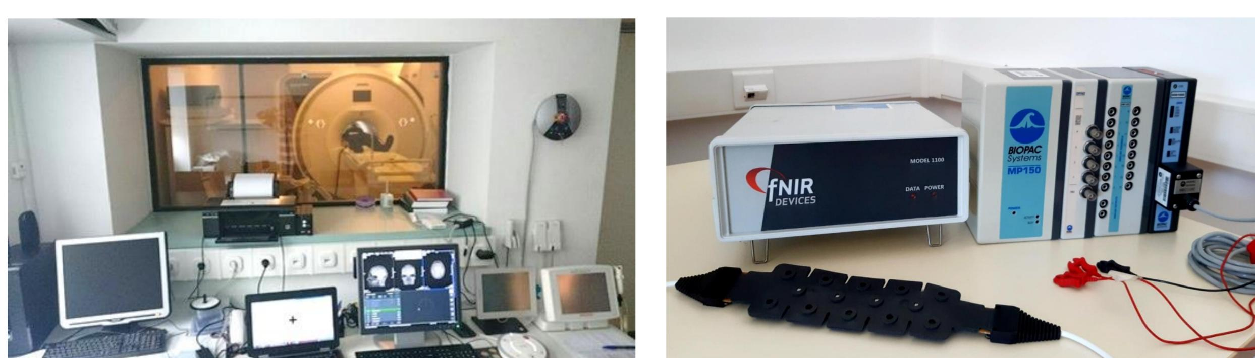
Slika 1. fMRI uređaj na Hrvatskom institutu za istraživanje mozga (lijevo). fNIRS uređaj u Laboratoriju za interaktivne simulacijske sustave na Fakultetu elektrotehnike i računarstva (desno).
