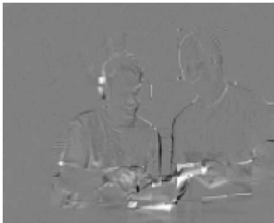
**Slika 3.13** Rezidualna slika, makroblokovi 16x16
