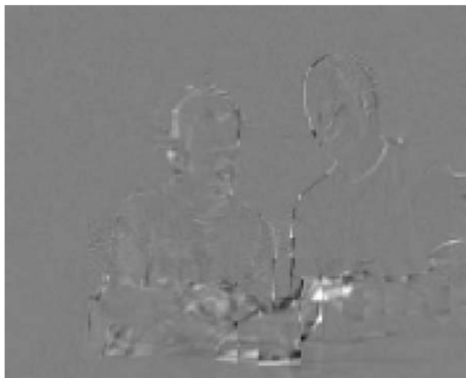
**Slika 3.14** Rezidualna slika, makroblokovi 8x8
