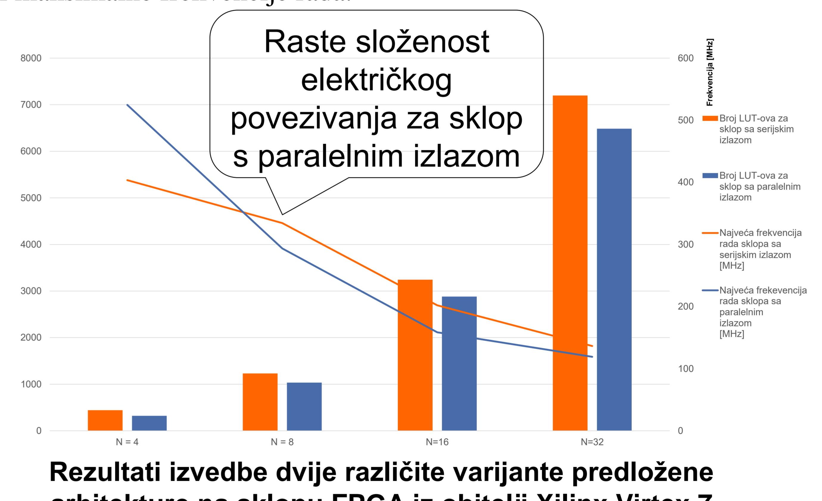
Isključenjem jedinice za serijalizaciju postižu se uštede u broju korištenih LUT-ova. Najveća frekvencija rada sklopa je manja za paralelnu konfiguraciju za  $N \geq 4$  zbog većeg kašnjenja na podatkovnim linijama uslijed složenijeg električkog povezivanja koje je potrebno za sklop s paralelnim izlazom.
