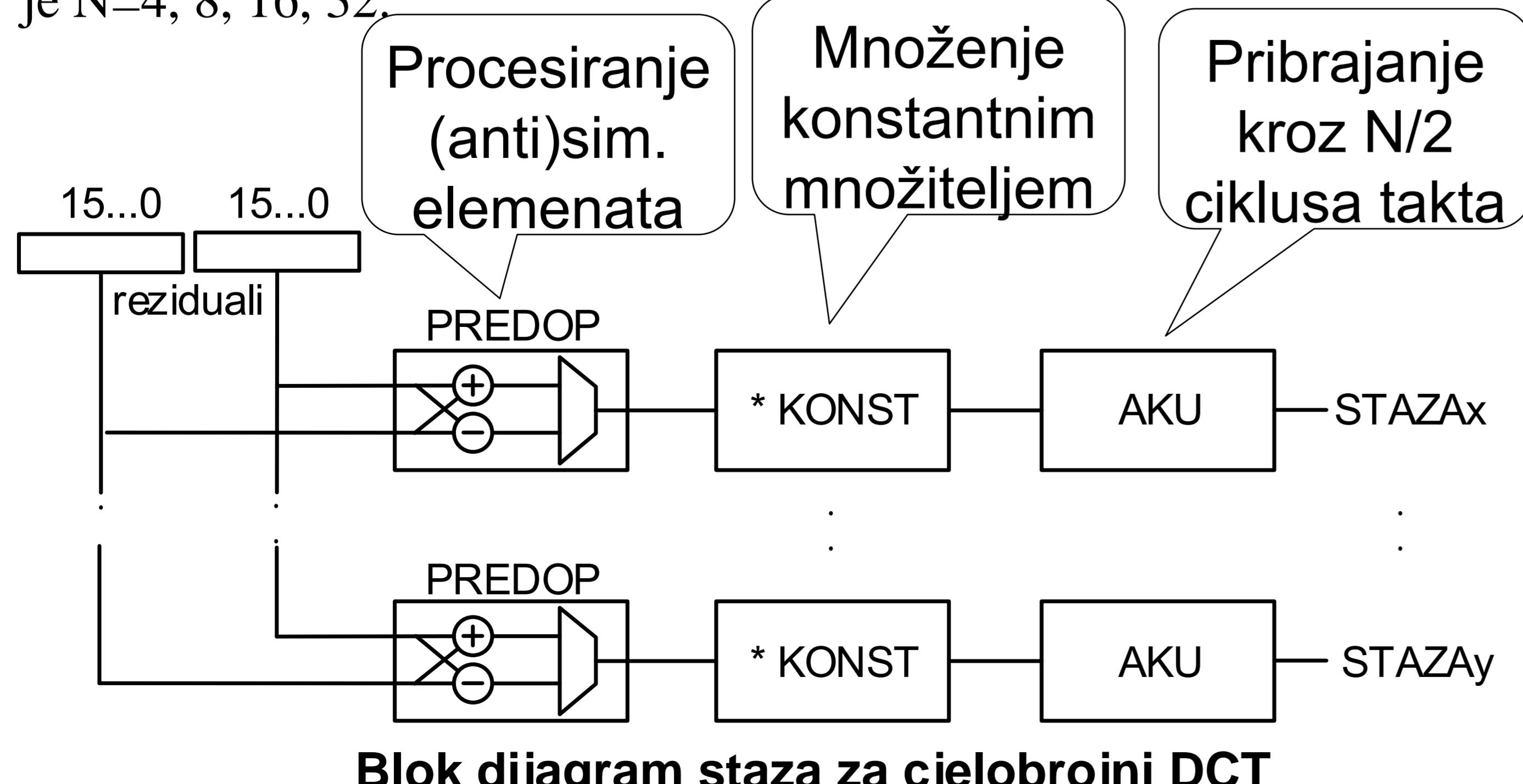
Iz jednadžbe je vidljivo da su u oba matrična množenja bazni vektori matrice D množenici što se može iskoristiti u projektiranju 2D DCT sklopa tako da se 1D DCT sklop, odgovoran za unutarnji umnožak ponovo iskoristi za vanjski umnožak.
